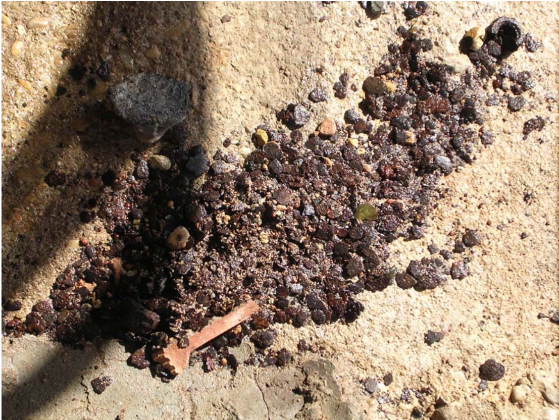
Foto 3.- Restos de tubería (fragmentos en forma de láminas) a los 150 m.
